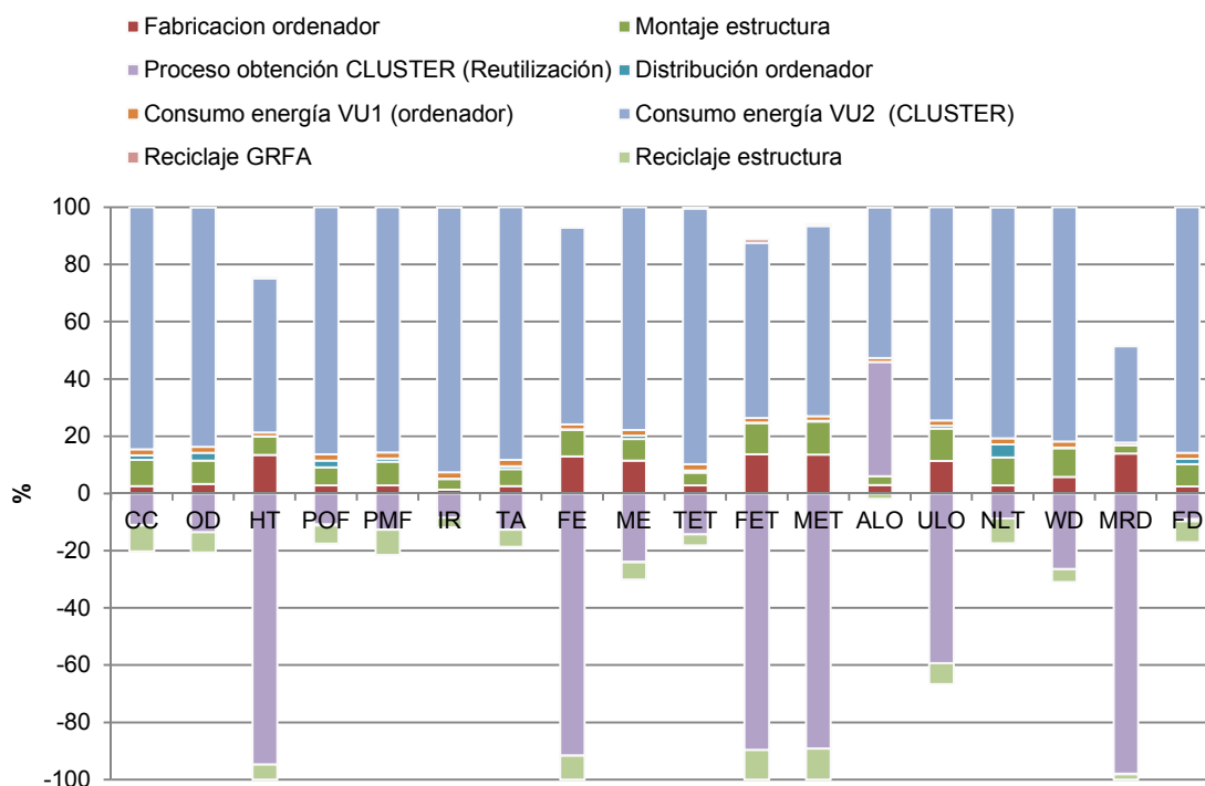
Figura 4. Evaluación de impacto del ciclo de vida de un ordenador cuyo destino al final de su vida útil es la preparación para la reutilización para obtener un CLUSTER (Demo II). Metodología ReCiPe MidPoint (H).
